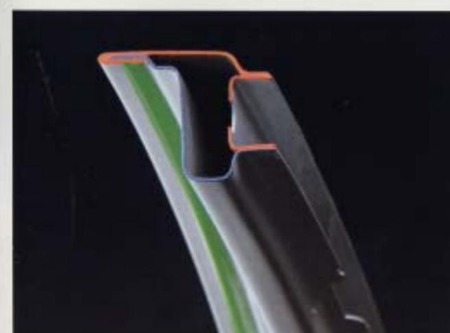
**Avtätad mot rost.** På särskilt utsatta ställen, som tex invändiga fälsar i motorhuv, dörrar och baklucka, speciallimmas plåtdetaljerna mot varandra. På så sätt förebyggs kontaktkorrosion mellan plåtarna. För att inte någon fukt skall kunna tränga in tätas fälsarna med PVC.
