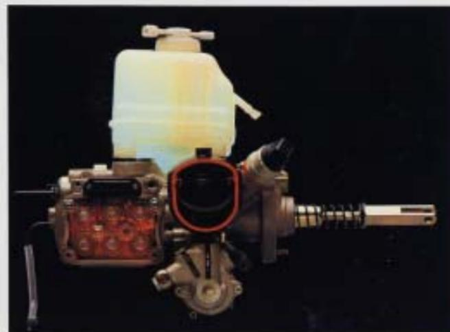
**ABS-bromsar.** Genom separata elektromagnetiska avdämpare på alla fyra hjulen ser Jettas avancerade fjäderska ABS-bromssystem till att du alltid får maximal bromsverkan på varje hjul oavsett underlag och samtidigt bibehåller styrformåga.
