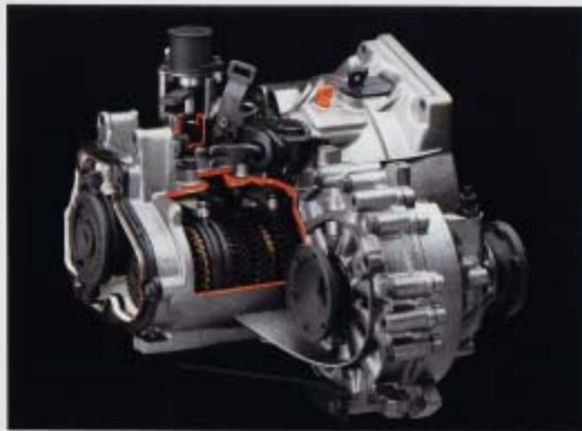
**Femväxlad växellåda.** Genom varvtalsminskningen i den femväxlade växellådan reduceras både ljudnivå och bränsleåtgång. Förutom att ett lägre varvtal innebär mindre försäkring, är drivaxlarna särskilt robusta lagrade med koniska rullager som bättnar till prestanda och ger längre livslängd.
