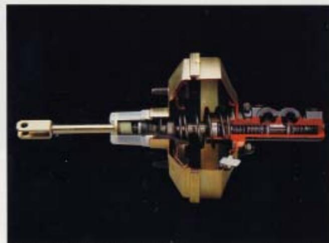
**Bromskraftförstärkare.** Med bromskraftförstärkaren bromsar man mjukt och säkert med lågt pedaltryck. Det undertryck som uppstår från motorn i insugningsröret, utnyttjas genom bromskraftförstärkaren till ett stödjande pedaltryck.
