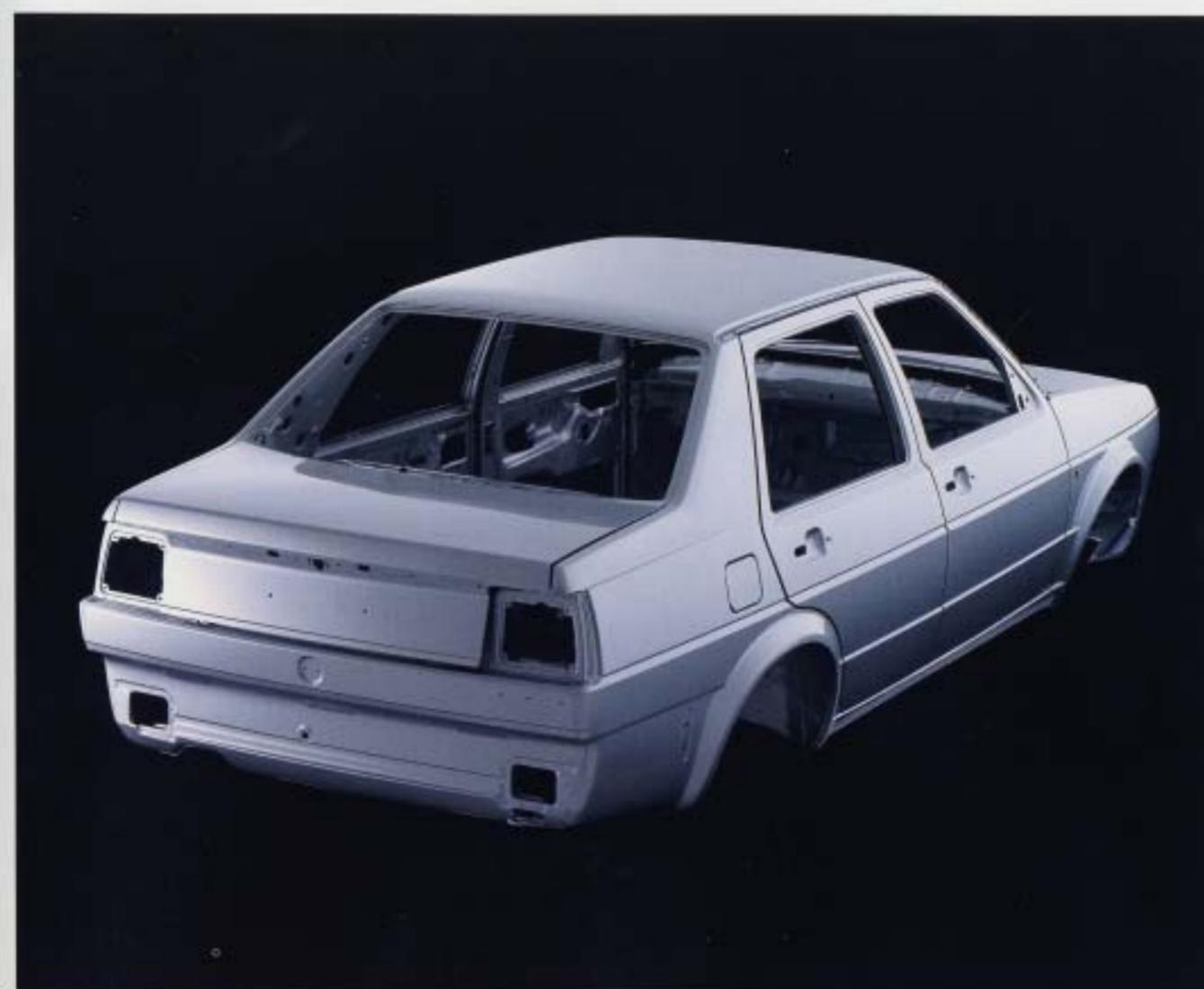
**Korrosionsskyddad kaross.** De delar av karossen som är särskilt utsatta för rost, som tex inidan av motorhuven, är silverlack i förzinkad plåt. Alla de nedre högheterna i karossen, dörrens och bakluckans baksida behandlas med hetvax som sprutas in i en effektiv helautomatisk process. På så sätt når vaxet även de mest avlägsna skymsken och vifv.
