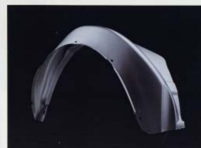
**Delar av plast och underredsbeklädnad.** De delar som är mest utsatta för stenskott, som tex de främre hjulhusen, är klädda i plast. Skarvar, fogar och fälsar tätas. Slutligen förses hela det område av bottenplåt som är mest utsatt för stenskott med ett tjockt, hållbart och elastiskt skikt av PVC-material.
