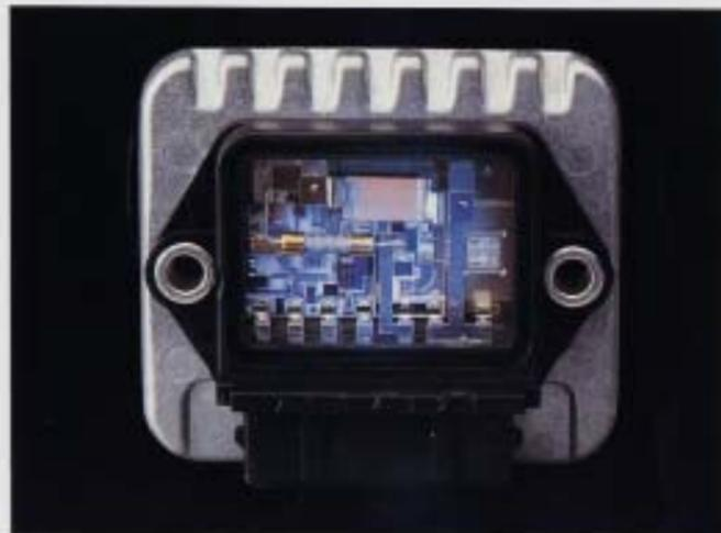
**Brytaren i det elektroniska tändsystemet.** Med transistorändringen får man en trygg start även under ogynnsamma väderleksförhållanden. Tändsystemet arbetar kontaktlöst och behöver därför, bortsett från att long-life tändstift byts var 3000:e mil, inte någon skötsel. Den kraftiga tändnistan skapar för en säker förbränning och därmed ett bra utnyttjande av bränsle-utbländningen.
