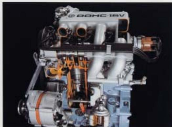
**16-ventilarsmotor.** Med hjälp av fyra ventiler till varje cylinder skapas ett betydligt större andningsrum för Jettas tvåställda, fyrcylindriga 1,6-liters GTI-motor, vilket också ger ännu bättre prestanda. Det avancerade bränslesprutningsystemet KE-Jetronic och de dubbla överliggande kamakarna stärker motorns fina gång vilket gör att den utvecklar 129 hk samt accelererar 0–100 km/h på 9,3 sek.
