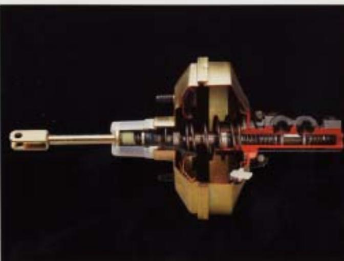
**Bromskraftförstärkare.** Med bromskraftförstärkaren bromsar man mjukt och säkert med obetydlig kraftförbrukning. Det undertryck som uppstår från motorn i insugningsbröret, utnyttjas genom bromskraftförstärkaren till att stötta pedalen.
