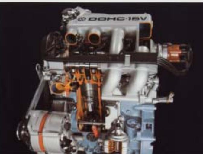
**16-ventilersmotorn.** Med hjälp av fyra ventiler till varje cylinder skapas ett betydligt större andningsrum för Golfs tvärställda fyrcylindriga 1,8-liters GTI-motor, vilket också ger innan bättre prestanda. Det avancerade bränsleinsprutningsystemet K-Jetronic och de dubbla överliggande kamslämmen säkrar motoren fine gång vilket gör att den utvecklar 129 hk samt accelererar 0–100 km/h på 8,0 sek.
