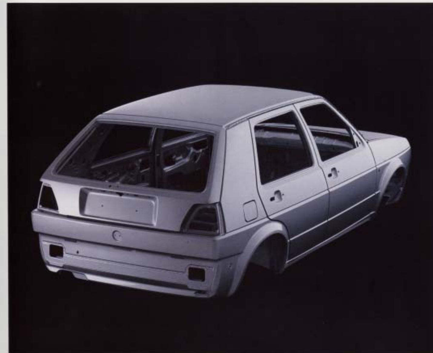
**Korrasionsskyddad karos.** De delar av karossen som är särskilt utsatta för rost, som tex innerplåten på motorhuven, är tillverkad i förzinkat plåt. Alla de nedre hölighetsdelarna i karosseriet, dörrarna och bakhacken bakom del behandlas med hettvax som sprutas in i en effektiv helautomatisk process. På så sätt når vaxet även de mest invändiga skyrmslan och vrål.
