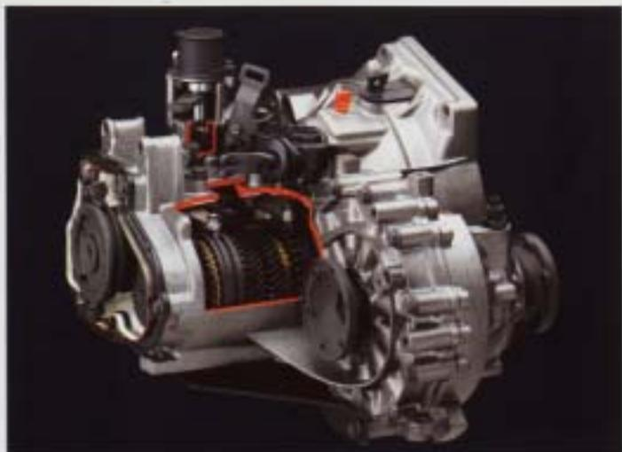
**Femväxlad växellåda.** Genom varvtalsminskningen i den femväxlaade växellådan reduceras både ljudnivå och bränsleförbrukning. Förutom att ett lägre varvtal innebär mindre förslingning, är drivaxlarna särskilt robust lagrade med keramiska rullagrar som bättre tål påfrestningar och ger längre livslängd.
