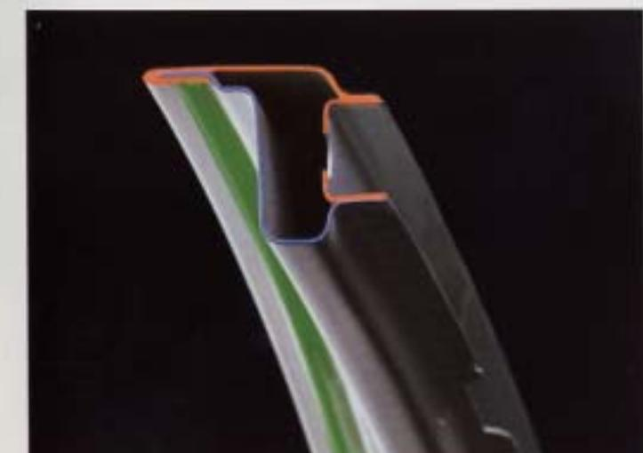
**Avtäckt mot rost.** På särskilt utsatta ställen, som tex invändiga falsar i motorhuv, dörrar och bakhacka, speciallimmas plåtdetaljerna mot varandra. På så sätt förebyggas kontaktkorrasion mellan plåtlämmar. För att inte någon fukt skall kunna tränga in tätas falsarna med PVC.
