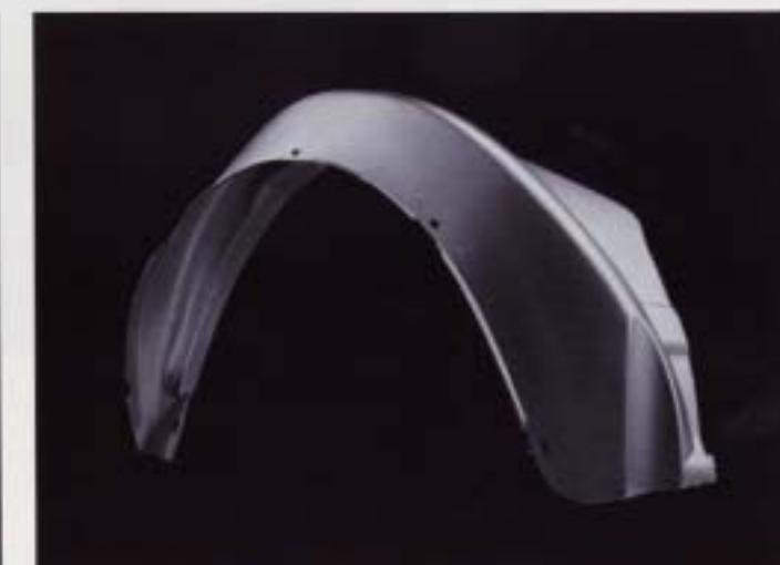
**Deler av plast och underredsbehandling.** De delar som är mest utsatta för stenskott, som t.ex. de närmre hjulhusen, är klädda i plast. Skarvar, fogar och falsar tätas. Slutligen fönsses heba del omvälden av botterplattan som är mest utsatt för stenskott med ett tjockt, hållbart och elastiskt skikt av PVC-material.
